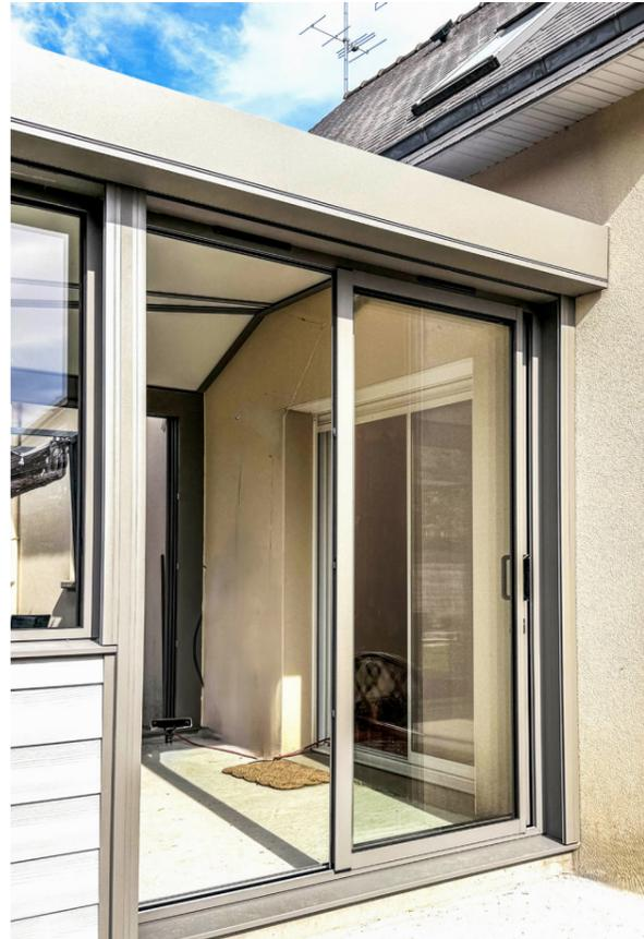
La toiture de cette extension **VÉRANDA RÉNOVAL** est équipée de panneaux isolants, 30 % plus performants que les modèles classiques. Ils offrent une isolation phonique renforcée et une membrane absorbant les bruits d'impact. Le plafond blanc intègre un éclairage LED et peut aussi accueillir un puits de lumière pour plus de clarté naturelle.
