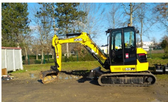
La mini pelle est utilisée pour les plus petits chantiers.
